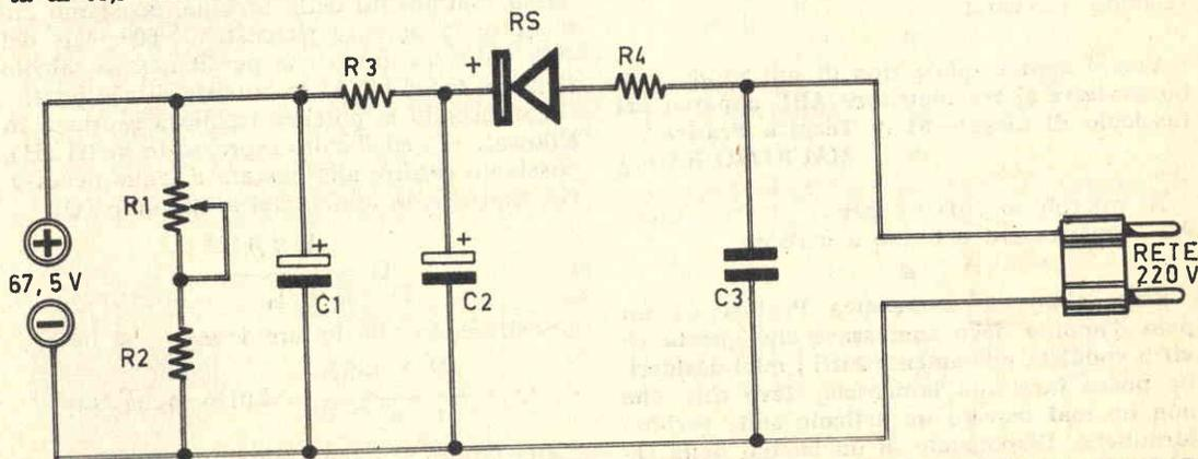
sto circuito non c'è molto da dire; il potenziometro R1 serve per regolare la tensione di uscita, perchè questa dipende anche dall'assorbimento del complesso che si intende alimentare. Per nessuna ragione si deve mettere in funzione l'alimentatore se questo non è collegato all'apparato da alimentare.
