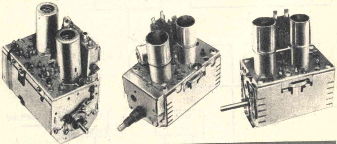
sul cambio canale, e precisamente sulle due valvole, provando a sostituirle con altre nuove; si dovranno controllare anche i circuiti di entrata relativi alle bobine L e ai condensatori C1-C2 (vedi schema elettrico).
