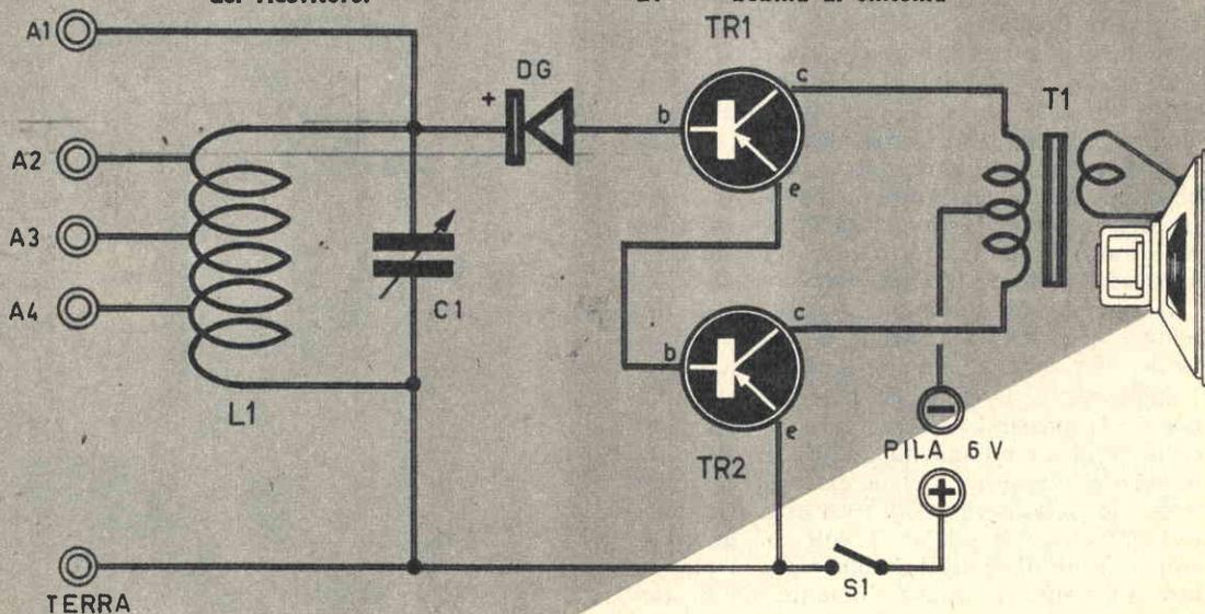
**Fig. 2 - Schema pratico del ricevitore Velox.**
