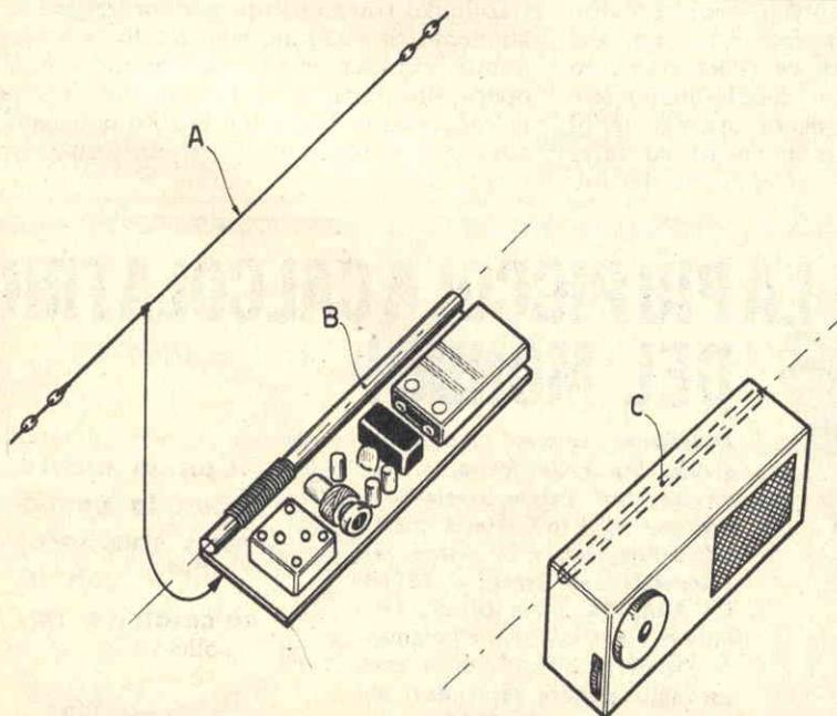
Fig. 2 - Per sfruttare la massima portata del trasmettitore FOLLETO, è necessario che il nucleo ferrocubo del ricevitore a transistori risulti parallelo all'antenna connessa con il trasmettitore... Il FOLLETO è venduto in scatola di montaggio, completa di astuccio custodia e ogni piccolo particolare. Può essere richiesto per sole L. 4.500 al Servizio Forniture di TECNICA PRATICA Via Gluck 59 - Milano. Versamento sul ns. C.C.P. N. 03/49018.
