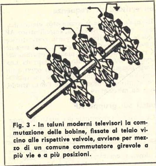
Fig. 3 - In taluni moderni televisori la commutazione delle bobine, fissate al telaio vicino alle rispettive valvole, avviene per mezzo di un comune commutatore girevole a più vie e a più posizioni.
