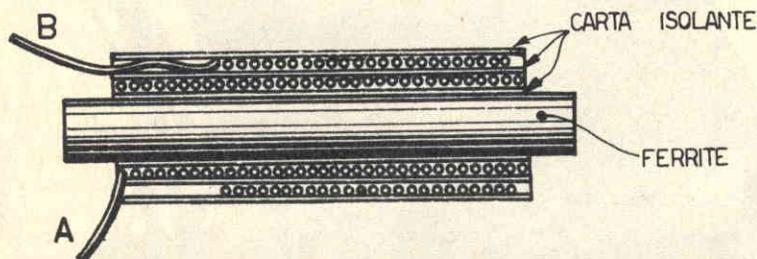
**Fig. 3 - Le bobine L1 e L2 sono perfettamente identiche. Ogni bobina è realizzata con due strati di filo per complessive 365 spire.**
