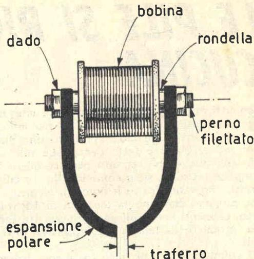
L'apparecchio smagnetizzante è costituito, principalmente, da una bobina che si può ricavare da un vecchio altoparlante. Le due espansioni polari sono rappresentate da altrettanti bracci di ferro dolce curvato alle estremità. La smagnetizzazione della testina del magnetofono si ottiene avvicinando ad essa, senza toccarla, le due espansioni polari.
