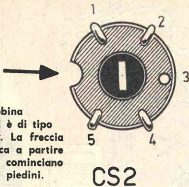
**Fig. 3 - La bobina di sintonia L1 è di tipo Corbetta CS2. La freccia indica la tacca a partire dalla quale si cominciano a numerare i piedini.**
