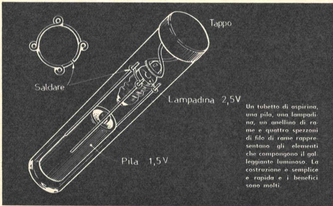
Un tubetto di aspirina, una pila, una lampadina, un anellino di rame e quattro spezzoni di filo di rame rappresentano gli elementi che compongono il galleggiante luminoso. La costruzione è semplice e rapida e i benefici sono molti.
