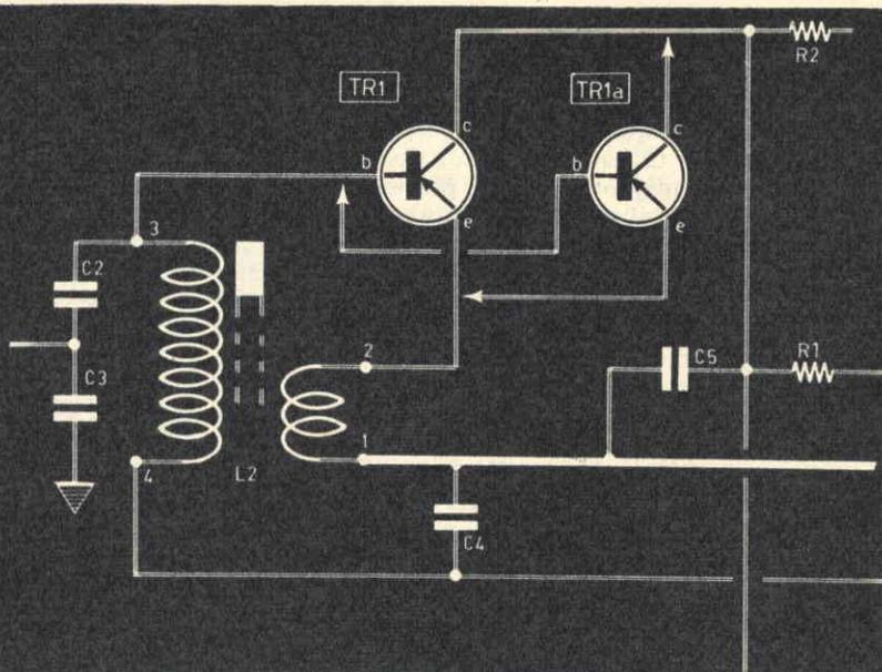
non possono sapere il significato di questa espressione. Ma la spiegazione è oltremodo semplice. Collegare tra loro in parallelo due transistori, significa, in pratica, introdurre sugli stessi fori in cui sono introdotti i tre terminali di un transistor i tre terminali dell'altro transistor; quindi il collettore del primo va saldato assieme al collettore del secon-
