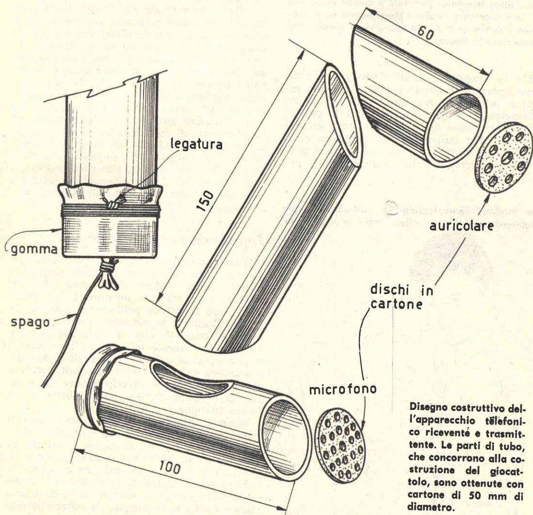
Disegno costruttivo dell'apparecchio telefonico ricevente e trasmittente. Le parti di tubo, che concorrono alla costruzione del giocattolo, sono ottenute con cartone di 50 mm di diametro.
